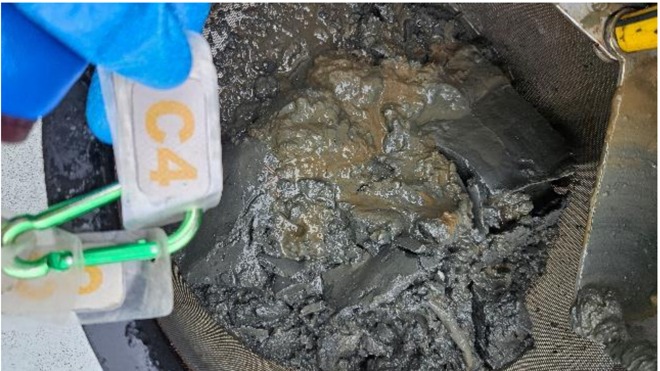
Figur 6-4: Bilde av sedimentet ved C4. Sedimentet besto av silt og leire. Foto: Aqua Kompetanse AS.
