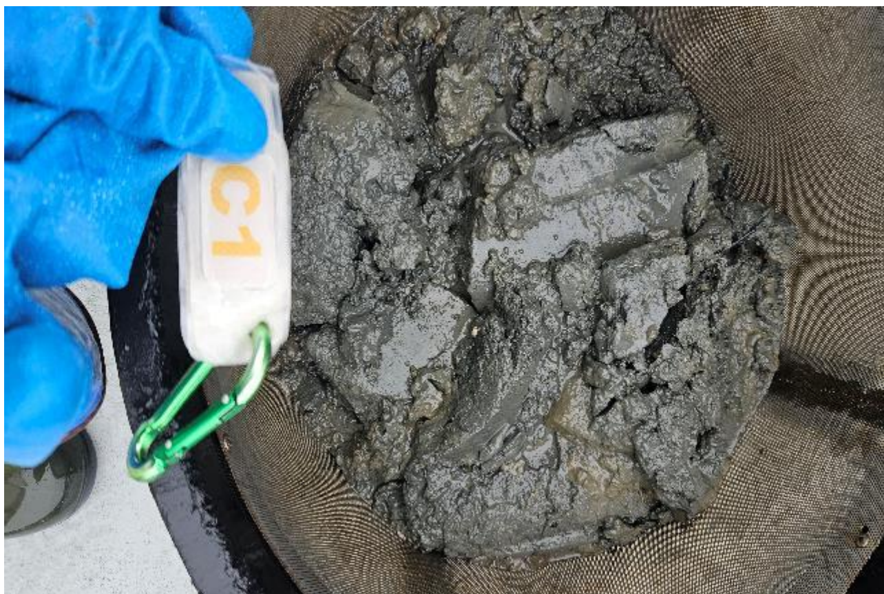
Figur 6-1: Bilde av sedimentet ved C1. Sedimentet besto av silt og leire. Foto: Aqua Kompetanse AS.
