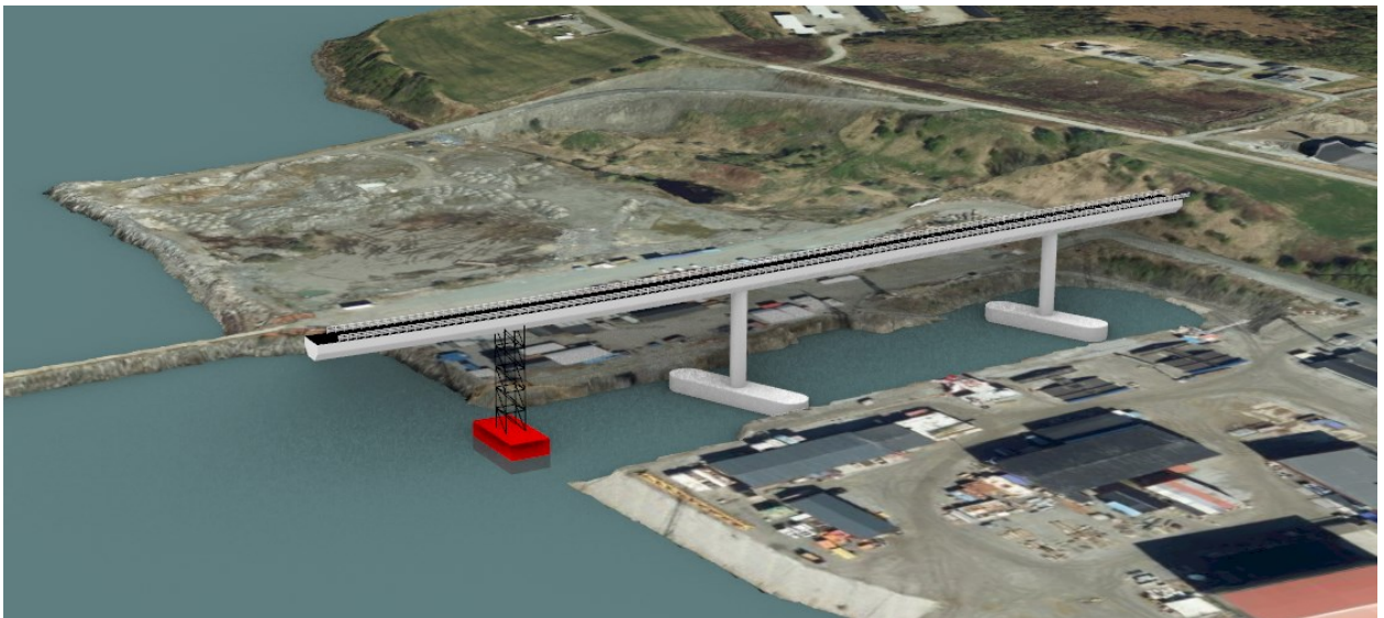
Figur 3-21 Høybru bygget med to pongtonger og en lekter
