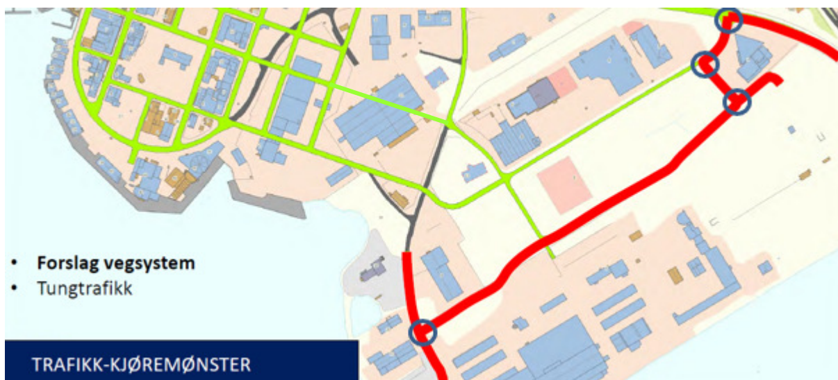
Figur 77. Tung trafikk til industriområdet. Kryss dimensjonert for modulvogntog er avmerket med blå sirkel.
