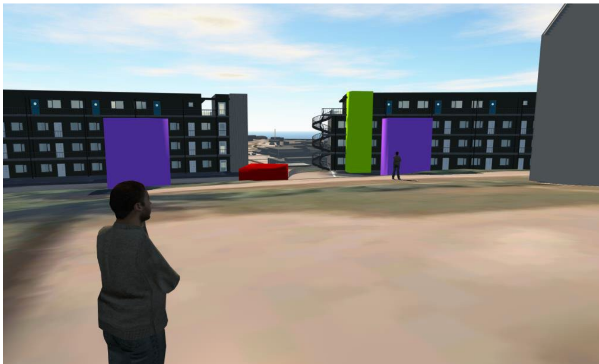
Figur 5 Illustrasjonen viser regulerte høyder fra gårdstunet til Bjørum gård: Grønn +49m, Lilla 44,4m og rød 40m.
