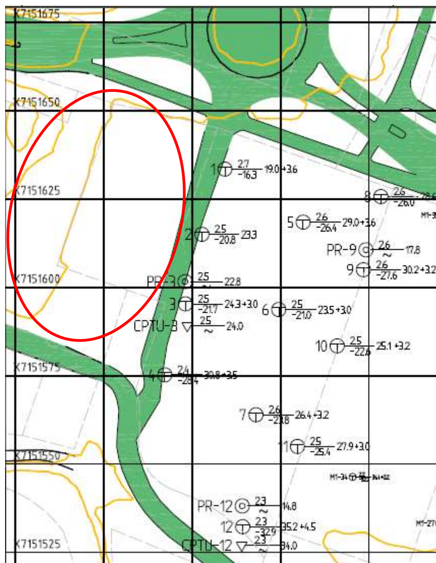
Figur 3 Utklipp fra borplan i rapport 416885-RIG-RAP-001 /7/ for Rock Garden like øst og sørøst for tomta i Gullvikvegen 15 (rød ring).
