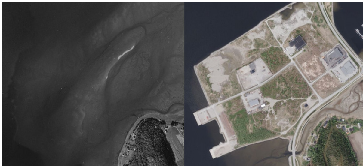
Figur 4. Industriområdet før og etter oppfyllingen
