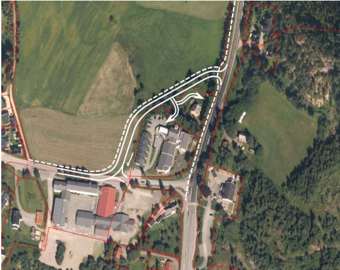
Figur 25: Prinsippskisse som viser alternativ 2 - kryssløsning fv.17/Bangsundveien. Gang- og sykkelvei er vist med stiplet strek.
