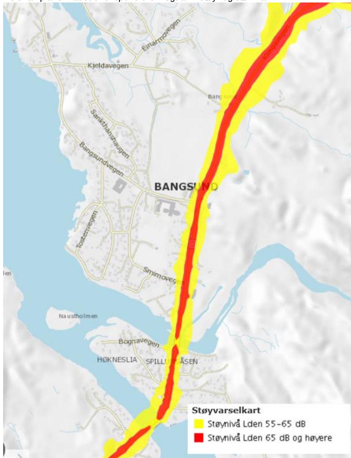
Figur 8: Støykart fra Statens vegvesen.
