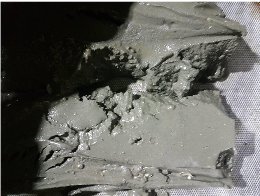
Figur 10: Bilde som viser sedimentet fra stasjon 4. Sedimentet besto av silt og leire.
