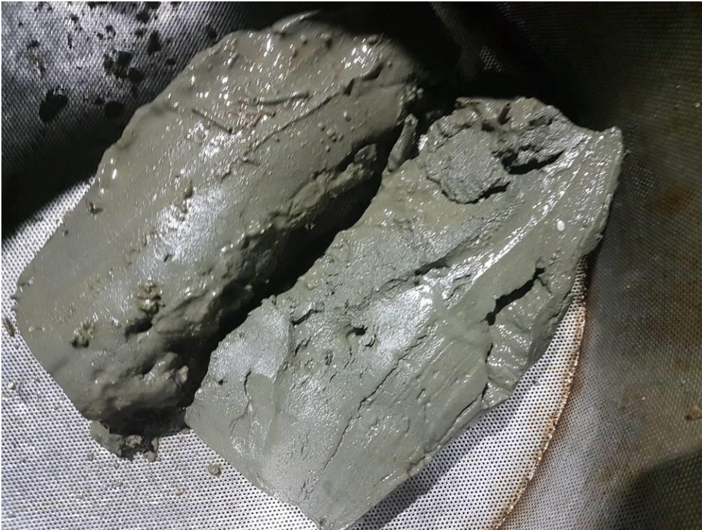
Figur 13: Bilde som viser sedimentet fra stasjon 7. Sedimentet besto av silt og noe leire.
