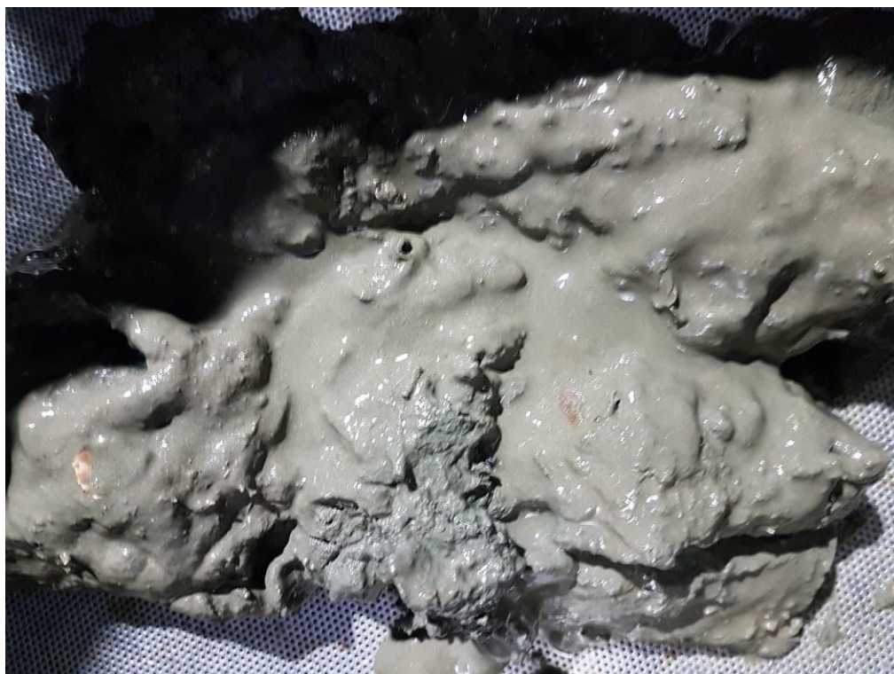
Figur 7: Bilde som viser sedimentet fra stasjon 1. Sedimentet besto av silt.
