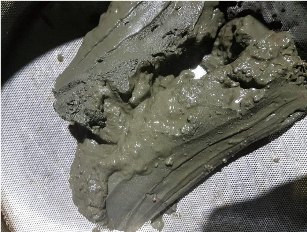
Figur 15: Bilde som viser sedimentet fra stasjon 9. Sedimentet besto av silt og leire.
