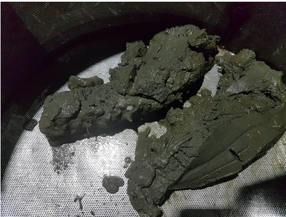
Figur 16: Bilde som viser sedimentet fra stasjon 10. Sedimentet besto av silt og leire.
