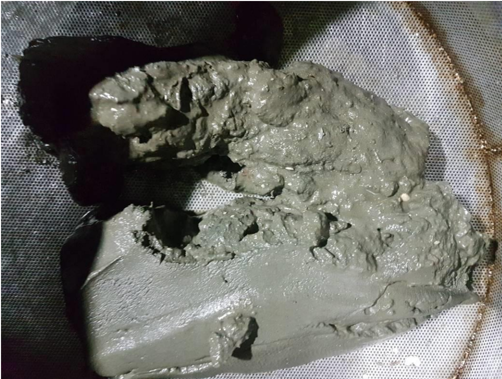
Figur 11: Bilde som viser sedimentet fra stasjon 5. Sedimentet besto av silt og leire.
