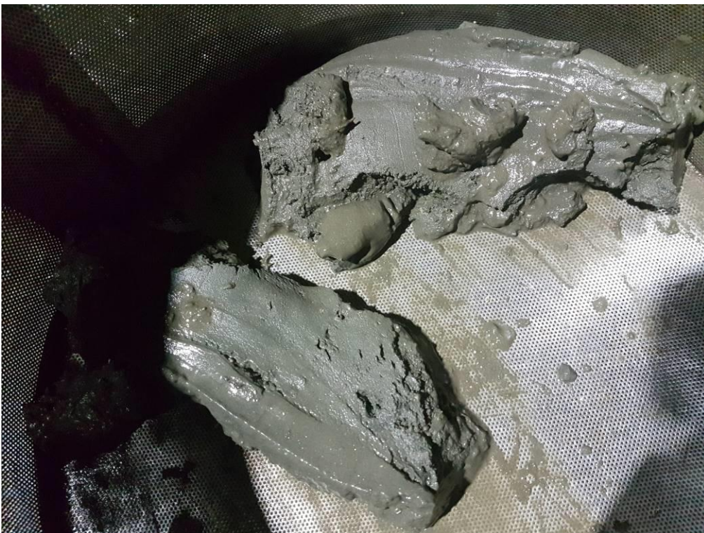
Figur 14: Bilde som viser sedimentet fra stasjon 8. Sedimentet besto av silt og leire.
