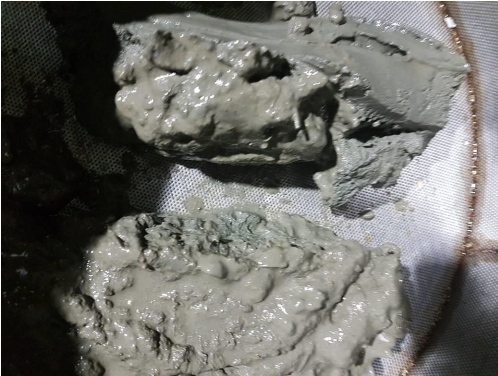
Figur 9: Bilde som viser sedimentet fra stasjon 3. Sedimentet besto av silt og leire.
