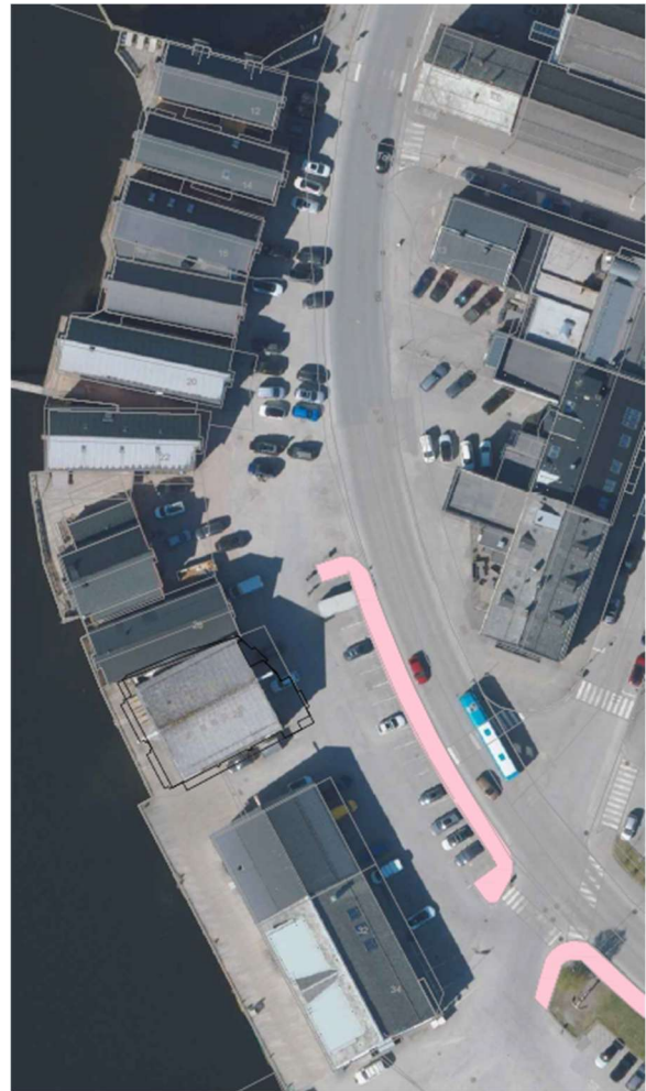
Figur 4. Avgrensning i form av fortau vist med rosa skravur. Det bemerkes at det er nedsenket kantstein, noe som innebærer falsk trygghet ettersom dette kun er et visuelt hinder og ikke et fysisk hinder
